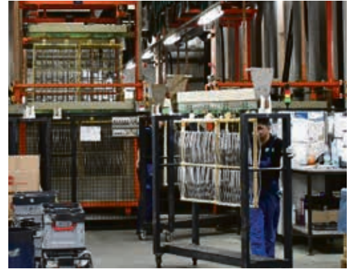
Metallveredelte Teile kommen hier gerade aus der Beschichtungsanlage.
